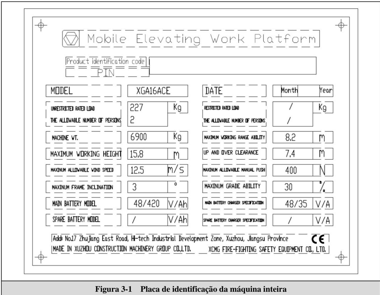
Figura 3-1 Placa de identificação da máquina inteira
