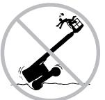
Dirija a máquina na posição retraída, com extremo cuidado e em baixa velocidade, ao passar por terrenos irregulares, detritos, superfícies instáveis ou escorregadias e próximo a buracos e declives acentuados.
