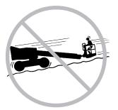
Limite a velocidade de operação de acordo com as condições da superfície, do congestionamento e da inclinação do solo, da localização de pessoas e de quaisquer outros fatores que possam provocar colisão.
