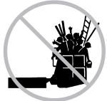
Não coloque escadas ou andaimes na plataforma ou apoiados em qualquer parte da máquina.
