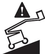
Se o sinalizador de inclinação tocar quando a máquina estiver elevada, a luz de sinalização Máquina não nivelada acende-se e a função de direção em um ou em ambos os sentidos não funciona. Identifique a condição da lança no declive como indicado em baixo.
