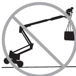
Não coloque nem fixe cargas fixas ou suspensas a qualquer parte desta máquina.
